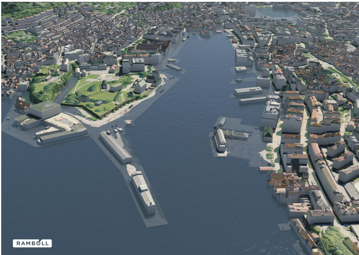
Figur 4 Vågen i Bergen med vannstand kote +2,37 m
